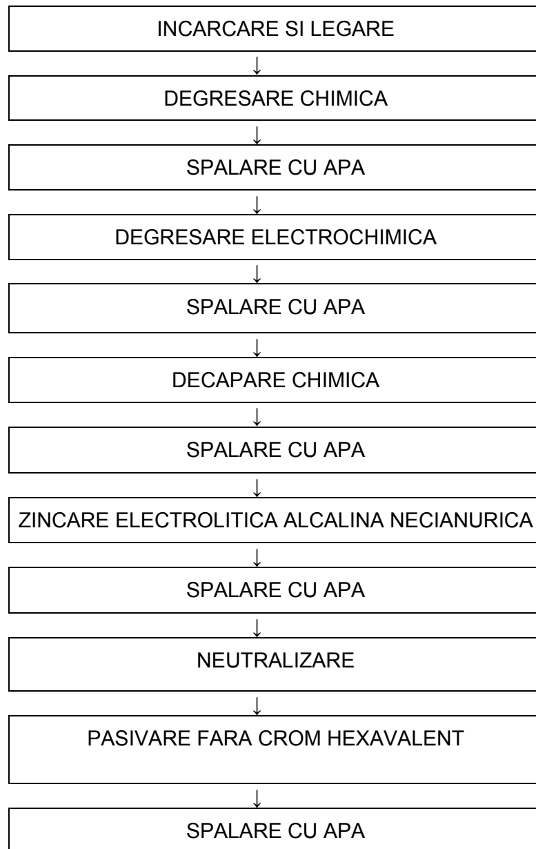
Figura nr. 37. Schema fluxului tehnologic la zincare electrolitica
