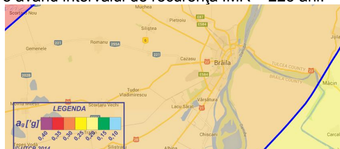
Fig. 12 – incadrarea zonei de realizare a podului peste Dunare pe harta accelerației terenurilor
