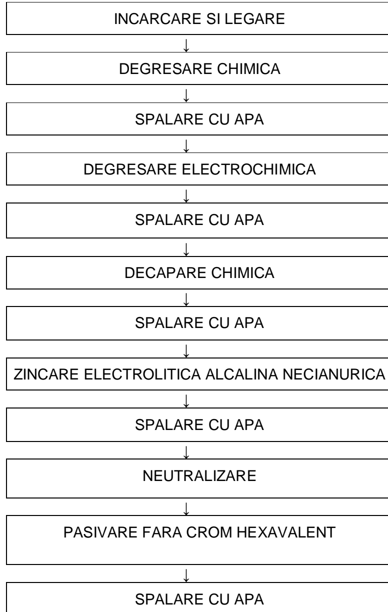
Figura nr. 21. Schema fluxului tehnologic la zincare electrolitica
