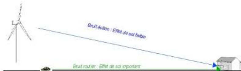
fig.36 - propagarea zgomotului pe un teren plat ( sursa :afsset )
