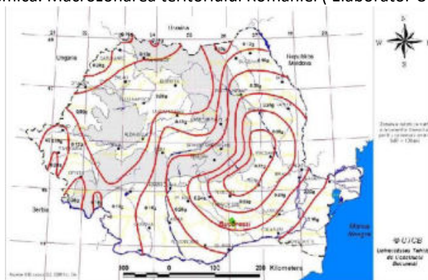
Fig. 17 - Zonarea seismica a teritoriului Romaniei - scara MSK conf. SR 11100 - 1:1993 Zonarea seismica. Macrozonarea teritoriului Romaniei ( Elaborator UTCB )
