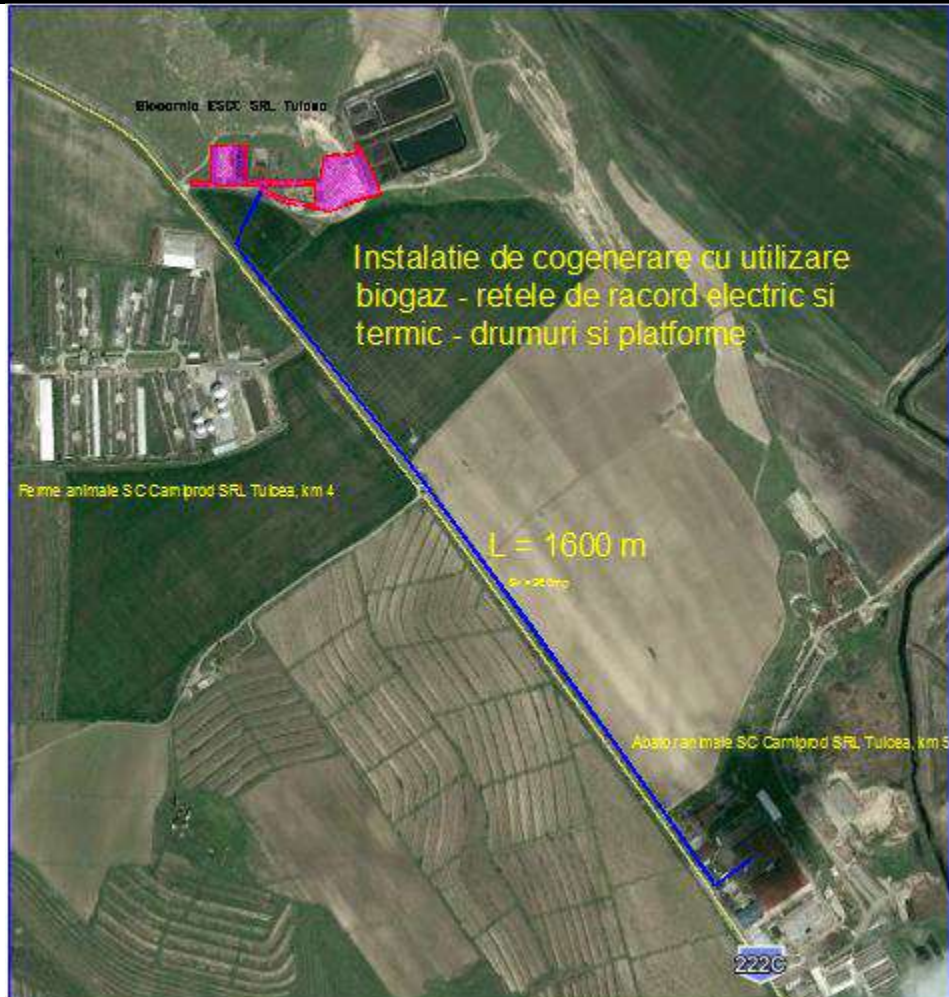
Fig. 1- pozitionare amplasament instalatie de cogenerare cu biogaz –retele racord electric si termic – drumuri si platforme
